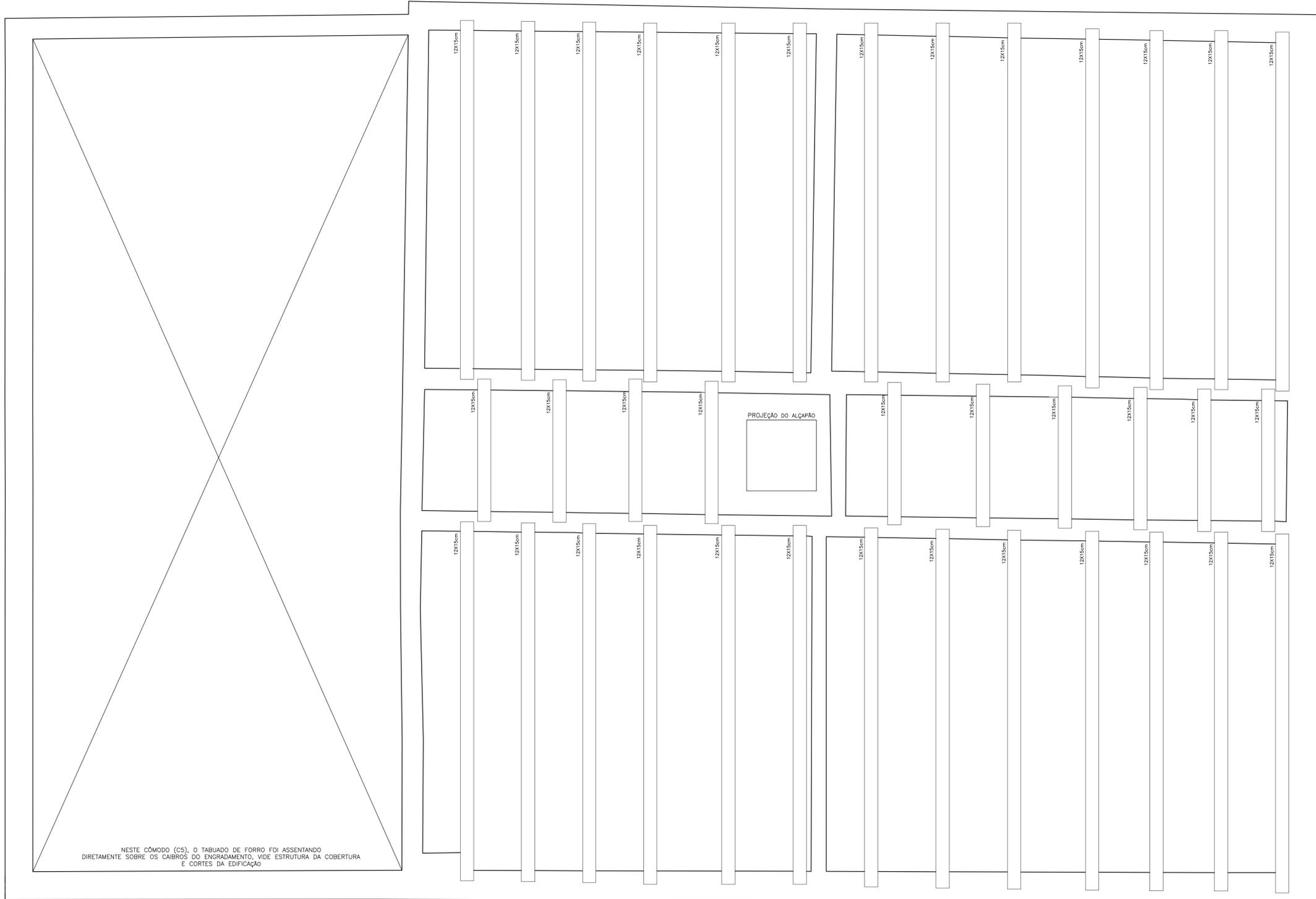
NESTE CÔMODO (C5), O TABUADO DE FORRO FOI ASSENTANDO DIRETAMENTE SOBRE OS CAIBROS DO ENGRADAMENTO, VIDE ESTRUTURA DA COBERTURA E CORTES DA EDIFICAÇÃO
